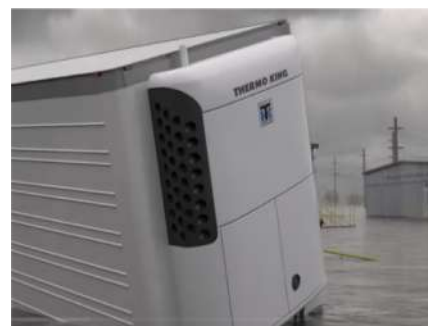
3-Remolques de refrigeración de respaldo fueron necesarios para mantener el peróxido a bajas temperaturas.
